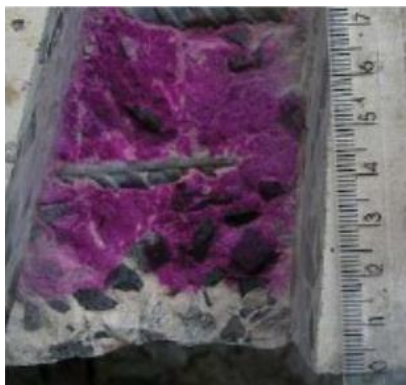
Figura 2: Ensaio com fenolftaleína para determinação da profundidade de carbonatação (Cimento Itambé).
